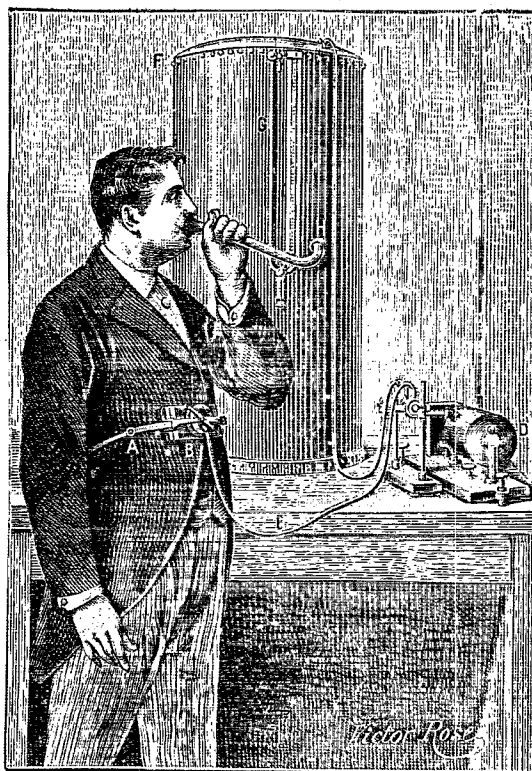
LA RESPIRATION CHEZ LES CHANTEURS (fig. 2). — Expérience faite au laboratoire de M. Marey, à l'aide du spiromètre et du pneumographe.
