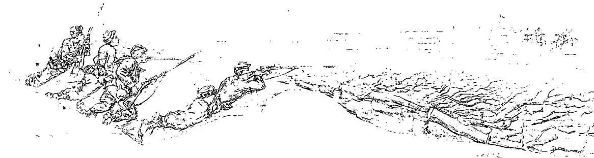
FIG. 3. — Profil et vue perspective d'une tranchée-abri pour tireurs couchés.
