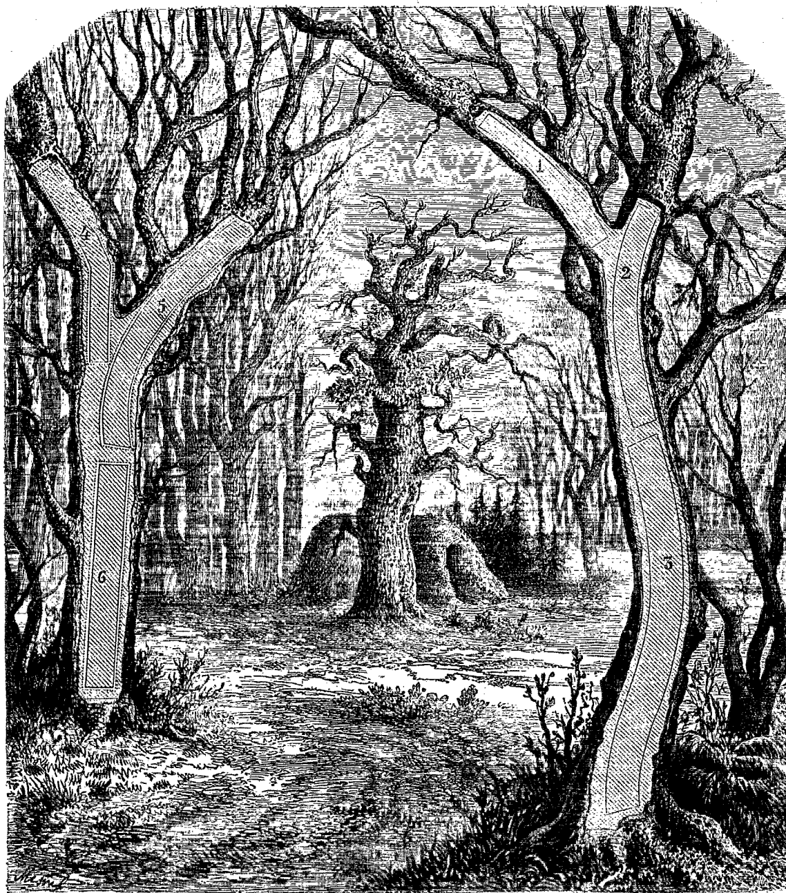
Choix des bois pour la marine. — 1. Bout d'allonge. — 2. Genou de porque. — 3. Cornière ou estain. — 4. Varangue accolée. 5. Guirlande. — 6. Seps de drisse.
