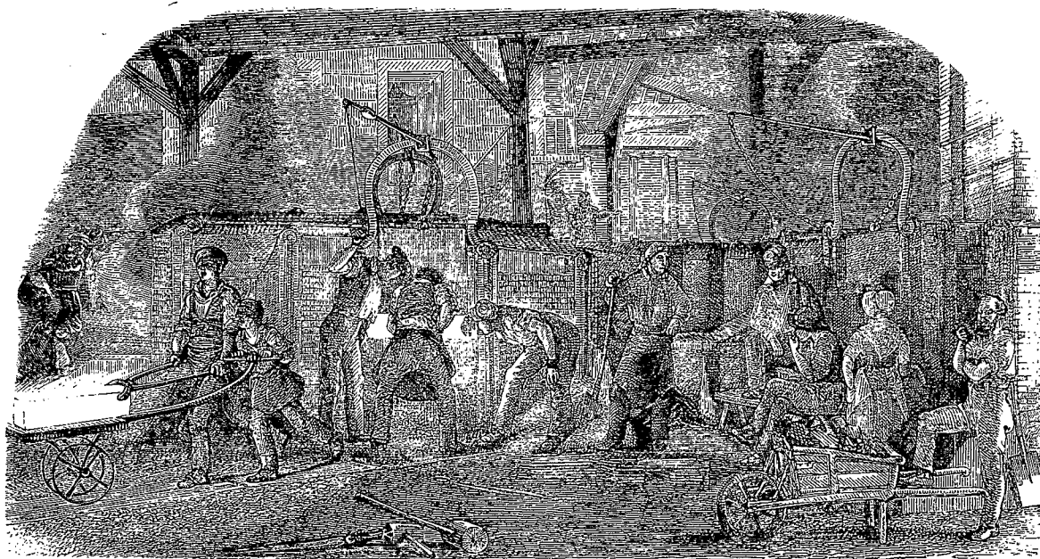
Fabrication du fer. — Fours à réchauffer les saumons de fonte.
