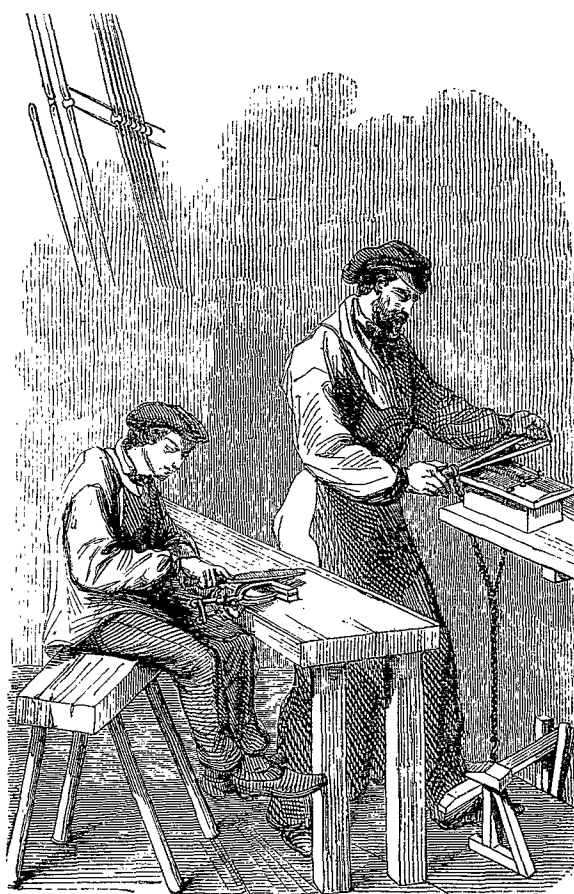
Fig. 6. Limage pour séparer les aiguilles nouvelles.
