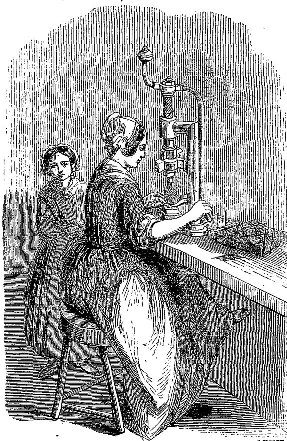
Fig. 5. Perçage ou formation du chas.
